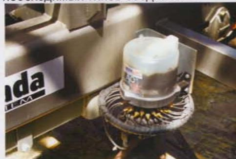
Доступность точек смазывания позволяет обеспечить простоту обслуживания. Имеется автоматическая централизованная система смазывания, которая гарантирует правильную смазку всех узлов. Таким образом, продлевается срок службы компонентов и всего прицепа, сокращается дорогое время простоя. Кроме того, в одном месте можно хранить ниппели для смазки, которые позволяют легко смазывать узлы вручную.
