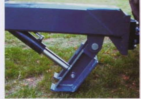
Дополнительная гидравлическая стойка может управляться при помощи гидравлики тягача или отдельного ручного насоса для обеспечения простого и безопасного соединения и отсоединения. Также имеются ручной винтовой домкрат или гидравлический механизм сопротивления.
