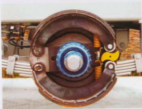
Тормоза S-Cam обеспечивают постепенное торможение и в то же время меньший износ тормозов при работе на высокой скорости. Повышается безопасность оператора, сокращается время простоя и эксплуатационные расходы.
