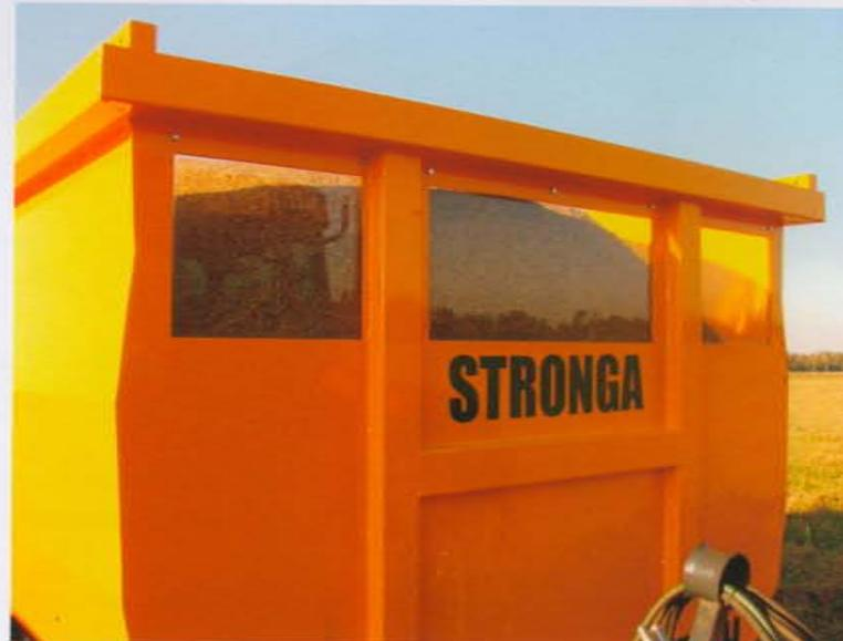
Большие окна впереди позволяют оператору хорошо видеть внутреннюю часть прицепа во время погрузки. По желанию также можно установить решетку на всю ширину.
