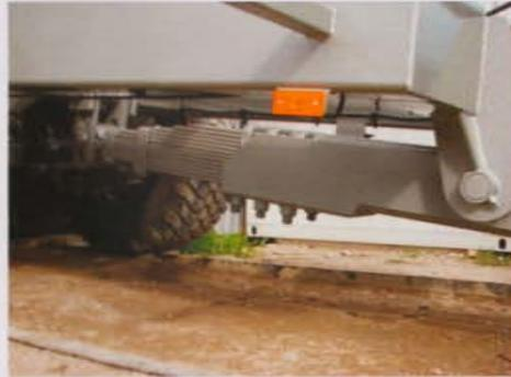
У всех прицепов есть жесткий тяговый стержень с регулируемой высотой в стандартной комплектации для достижения наиболее подходящей высоты при движении и баланса прицепа. Регулируемый подпружиненный тяговый стержень или стержень на резиновых подушках также имеются в качестве дополнительных вариантов для обеспечения более мягкой езды на высокой скорости и меньшей нагрузки на тяговый стержень тягача.
