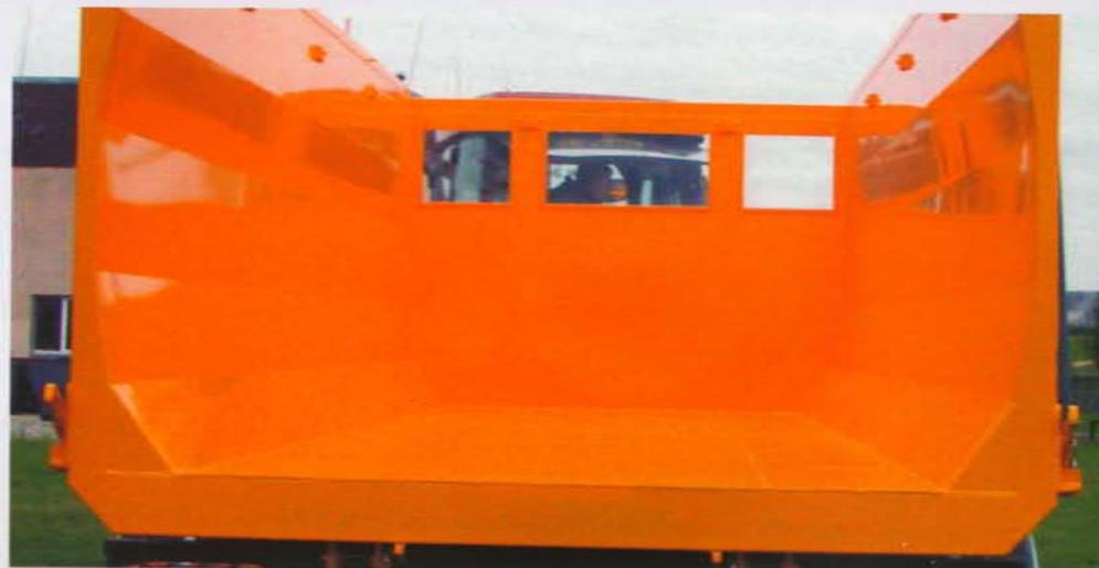
Сужающийся изогнутый кузов «BulkLoada» спроектирован таким образом, чтобы полностью использовать максимальную допустимую ширину. Суженная форма кузова и гладкие бока гарантируют аккуратную, простую и быструю разгрузку.
