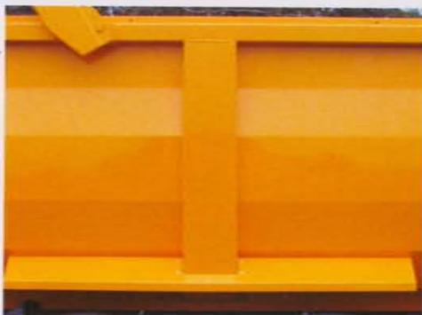
Широкая опора кузова распределяет нагрузку по всему кузову и ходовой части прицепа.
