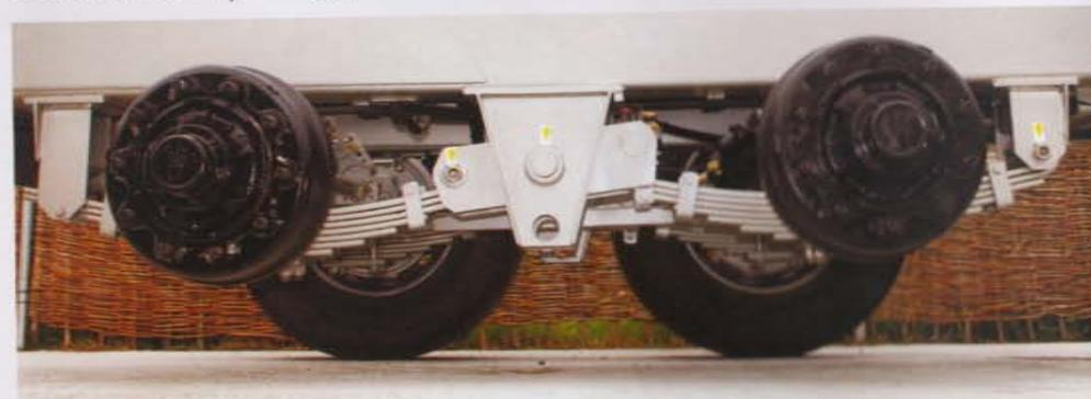
В стандартной комплектации оси снабжаются индивидуальными створчатыми или многопарабольными пружинами для тяжелых условий эксплуатации, делая транспортное средство идеальным для работы на дорогах и вне дорог. Такая подвеска также обладает дополнительным преимуществом особой износостойкостью и стабильностью.
