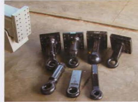
Приваренная многопозиционная фасонка типа Schar Müller повышает гибкость «BulkLoada», позволяя соединять ее с разными тягачами. Эта система позволяет использовать взаимозаменяемые типы фасонки с возможностью регулирования оптимальной высоты.
