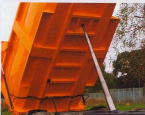
Рибристое днище поддерживает листовую пол, дополнительно укрепляя опрокидывающую часть и добавляя мощности в нужных местах.
