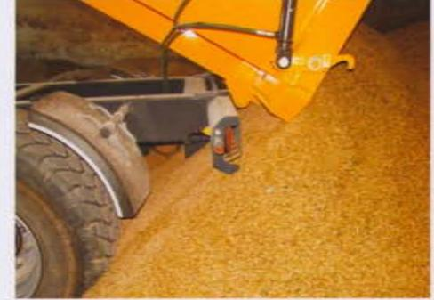
Большие смазываемые подшипники для опрокидывания снабжены для опрокидывания болтами 45 мм, установленными в фосфорно-бронзовых втулках, просто и прочно. Ось поворота расположена так, чтобы высота опрокидывания была оптимальной.
