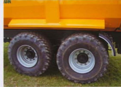
Стальные щиты от грязи, включенные в стандартную комплектацию, с жесткой пластмассовой задней частью и брызговиками. Их крутой угол предотвращает скопление зерна или других веществ.
