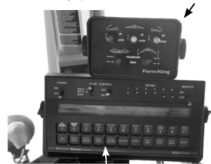
Контроллер управления распылением от компании Raven
