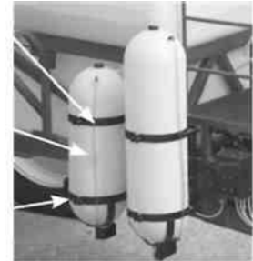
Положение установки пенного маркера, вид справа спереди
