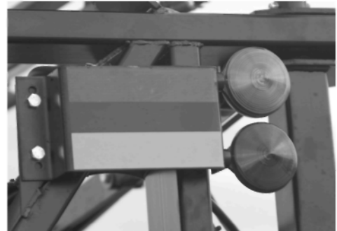
Задние отражающие и флуоресцентные ярлыки габаритных огней
