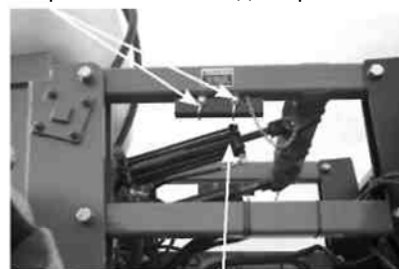
Параллельный цилиндр, вид слева
