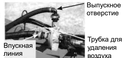
Центробежный насос с гидравлическим приводом
