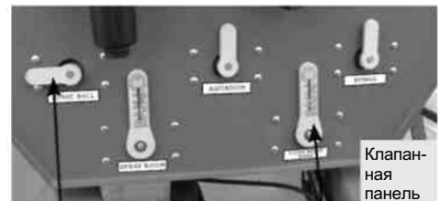
Кран промывки бака, открытое положение Кран подачи промывочной воды, закрытое положение Клапанная панель
