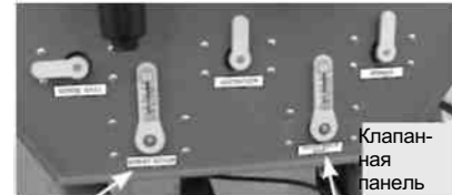
Отсечной клапан штанги, закрытое положение Кран подачи промывочной воды, закрытое положение Клапанная панель
