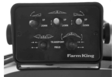
Блок управления штанги
