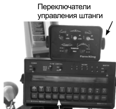
Контроллер управления распылением от компании Raven
