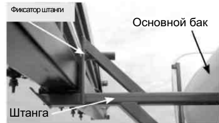
Штанга опрыскивателя вертикальной складки, вид слева
