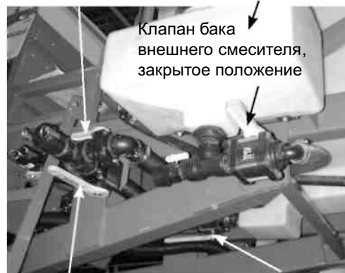
Кран быстрого заполнения раствором, открытое положение Главный клапан бака раствора, открытое положение
