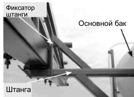
Штанга опрыскивателя вертикальной складки, вид слева
