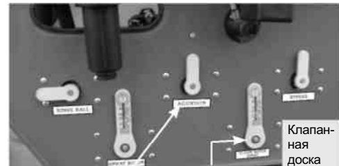
Кран включения перемешивания и кран подачи промывочной воды, закрытое положение Клапанная доска
