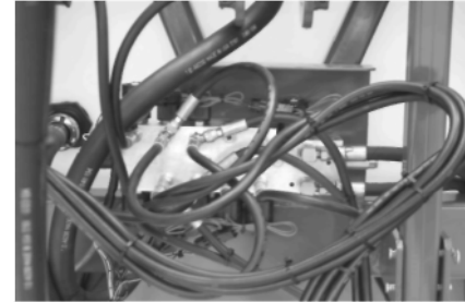
Настойка гидросистемы с запираением в среднем положении порта гидравлического блока «Открытый/Закрытый центр» с гидравлическим приводом, вид сзади
