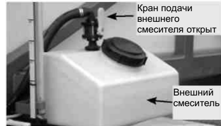
Внешний смеситель (дополнительный), вид слева
