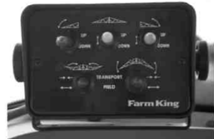
Блок управления штанги
